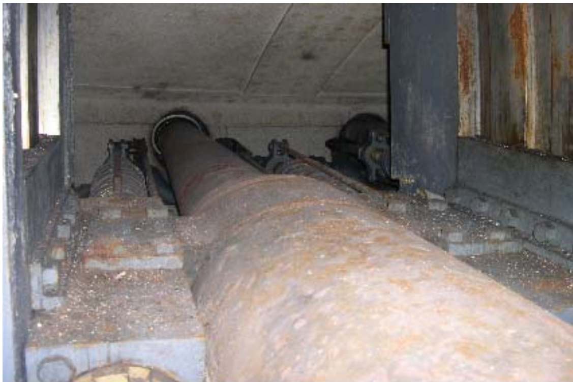
Un canon sur son berceau et cylindres de frein de recul
